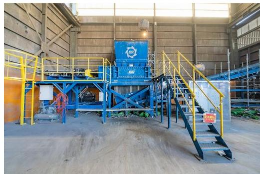
つくば工場 SSI社製 2軸破砕機
