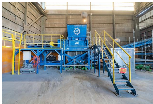
つくば工場 SSI社製 2軸破砕機
