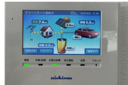
太陽光発電パネル・蓄電池・EV車の 電気の見える化
