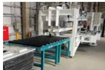
精度の高いソーラーパネルのリサイクルを実現するプラスト工法のフレーム取り外し機
