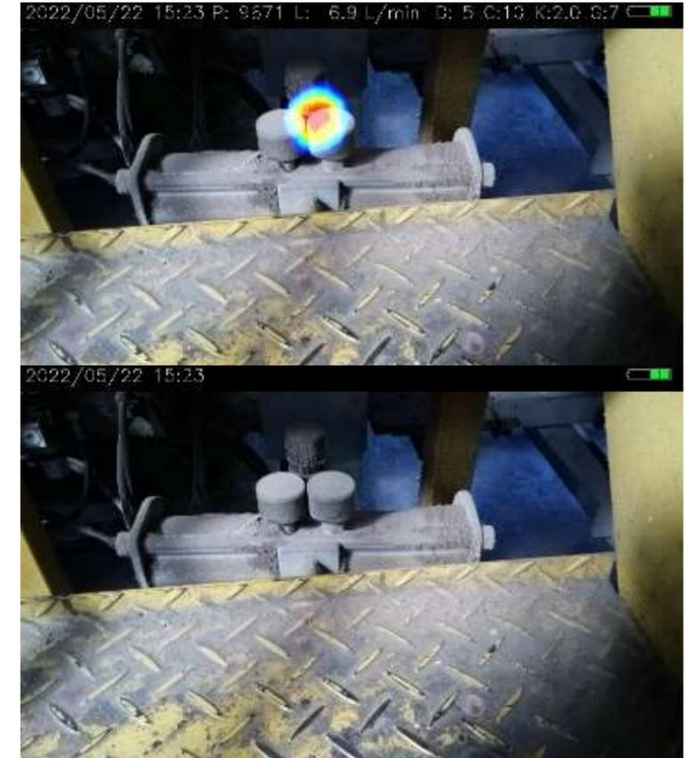
写真 エアー漏れ診断画像と調整後
